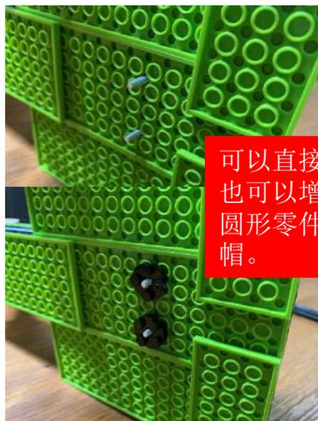
可以直接上螺帽, 也可以增加两个圆形零件后上螺帽。
